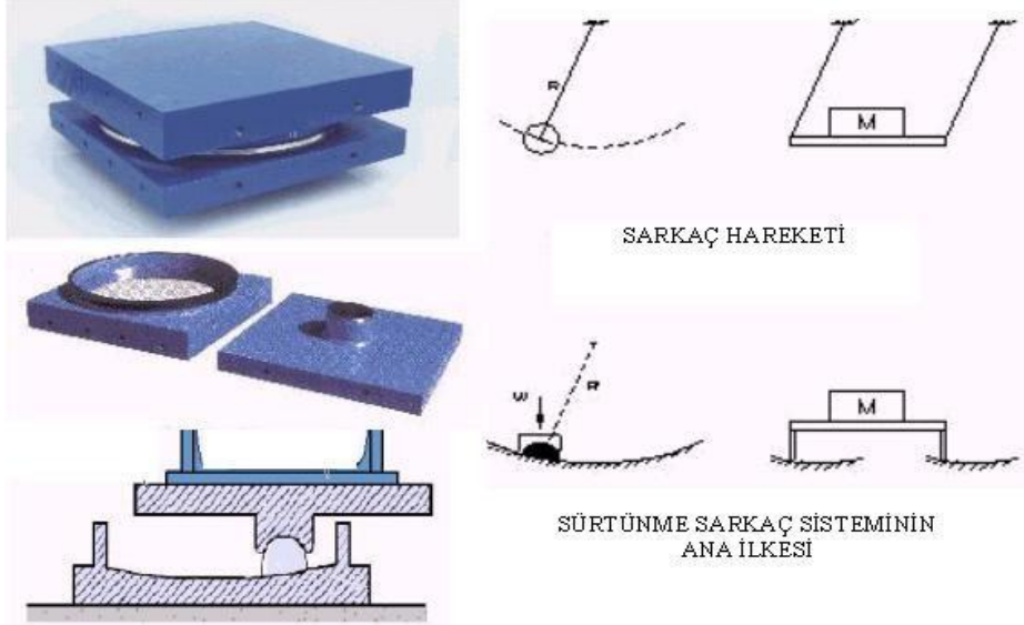
Şekil 9: Sürtülmeli Sarkaç Sisteminin Ana İlkesi
